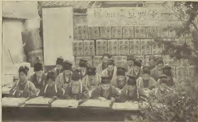
Fig. 5. - Recuento de hojas y disposición de las mismas en resmas
